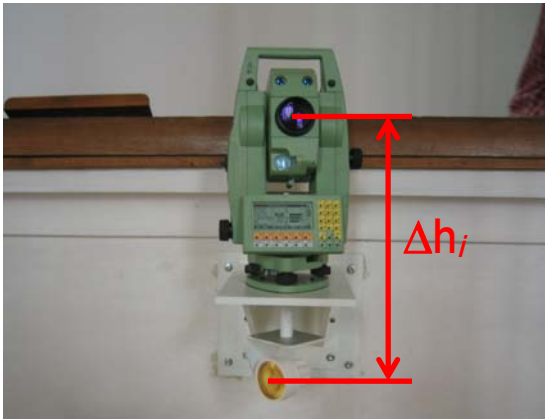
Abb. 10a) Kombiniertes Stand- und Objektpunkt (Prisma vertikal unter Instrument kann von weiterem Tachymeter angezielt werden, \Delta h_t = \text{const.} ist aus Laborkalibrierung bekannt)
