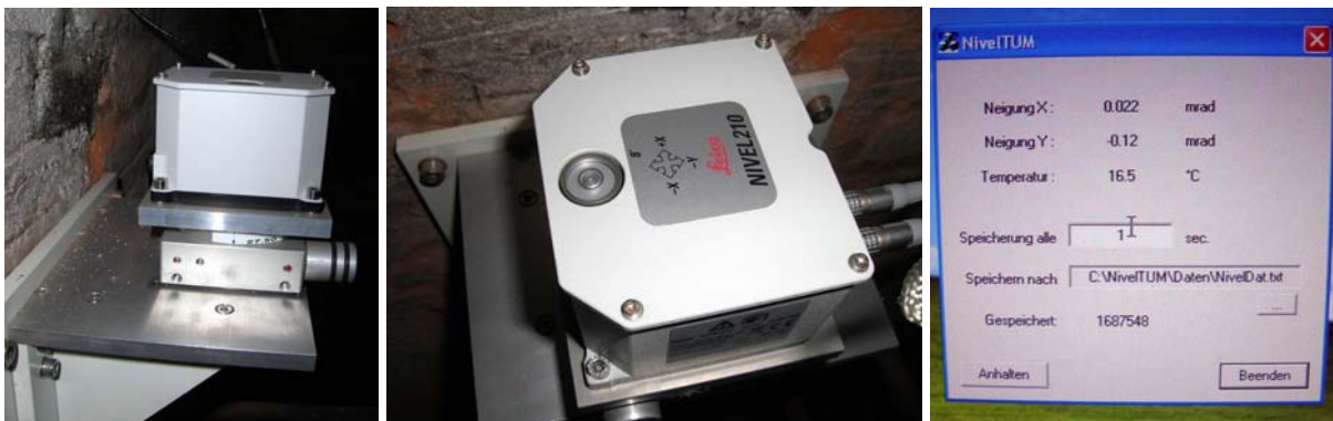
Abb. 13a bis c: Neigungssensor NIVEL210 im Turm des Münchener Doms auf Konsole mit Drehtisch, Ansicht des Konsole von oben und Ablesung des Rechners
