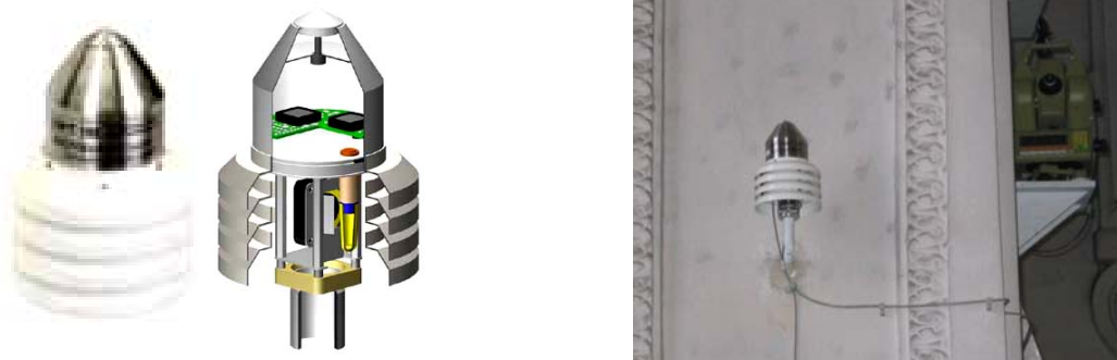
Abb. 14a und 14b: Meteorologische Sensoren: Reinhardt DMT IMV (links) und eingebaut im Innenraum
