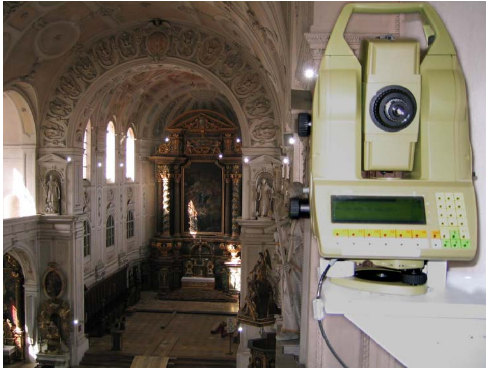
Abb. 12: Monitoring Systemaus aus Sicht des Robot-Tachymeters ( Jesuitenkirche zu Landshut )
