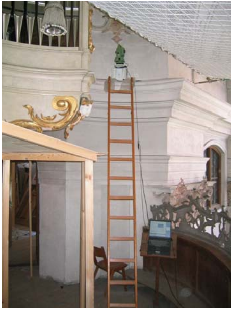
Abb. 12a & 12b: Standpunkte (Tachymeter auf massiver Konsole mit Diebstahlsicherung)
