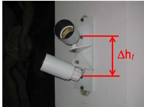
Abb. 14b) Kombiniertes Objekt-/Verknüpfungspunkt (Doppelprisma vertikal übereinander auf gemeinsamer Grundplatte, kann von mehreren Tachymetern gleichzeitig angezielt werden, \Delta h_t = 100 \text{ mm} = \text{const.} )
