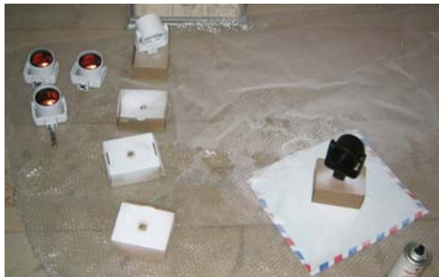
Abb. 12a & 12b: Standpunkte (Tachymeter auf massiver Konsole mit Diebstahlsicherung)
