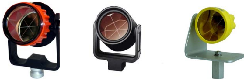
Abb. 11a bis 11c: Prismen Nedo mit Halter, Leica GPR1 mit Halter GPH1 (Genauigkeitsspezifikation (Hersteller) \ll 1 \text{ mm} ) und Leica Spezial-Prisma GPR112 mit Halter GHT112 (Tunnelbau) (Genauigkeitsspezifikation (Hersteller) < 1 \text{ mm} (Erfahrungswert ähnlich GPR1 ))
