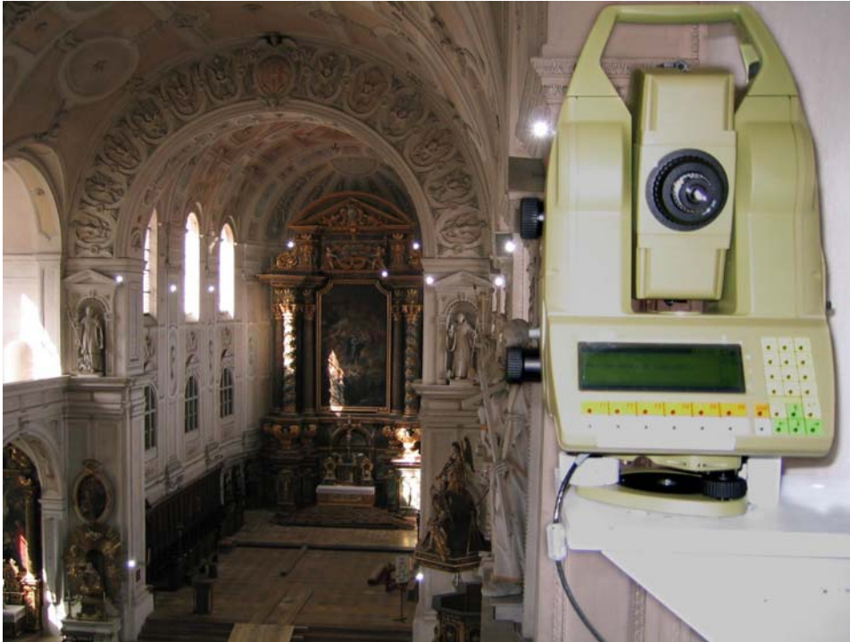
Abb. 16: Monitoring Systemaus aus Sicht des Robot-Tachymeters ( Jesuitenkirche zu Landshut )
