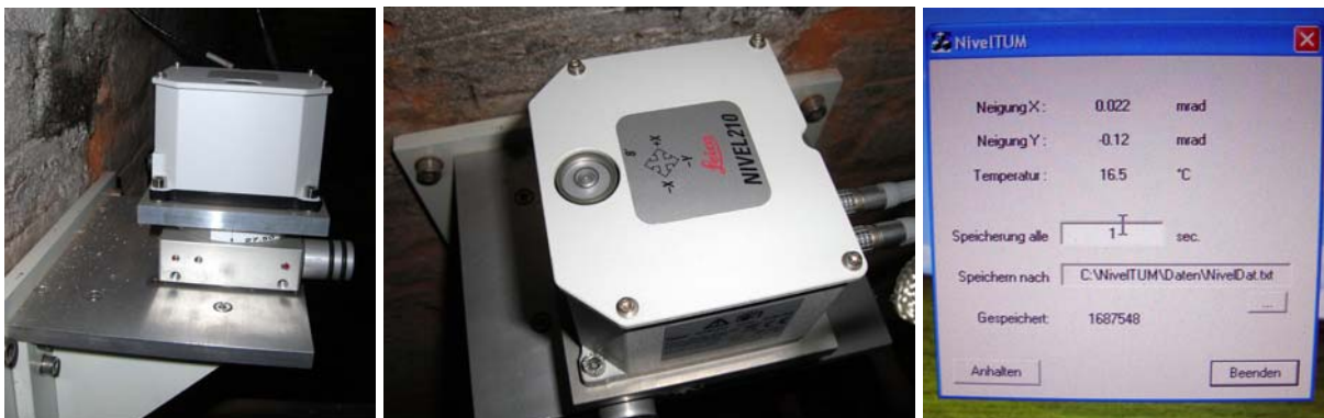
Abb. 17a bis c: Neigungssensor NIVEL210 im Turm des Münchener Doms auf Konsole mit Drehtisch, Ansicht des Konsole von oben und Ablesung des Rechners
