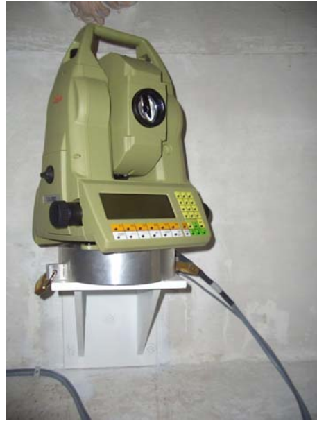
Abb. 12a & 12b: Standpunkte (Tachymeter auf massiver Konsole mit Diebstahlsicherung)
