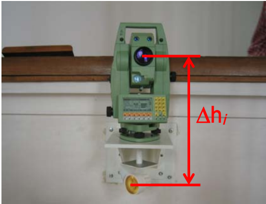
Abb. 13a) Kombinierter Stand- und Objektpunkt (Prisma vertikal unter Instrument kann von weiterem Tachymeter angezielt werden, \Delta h_i = \text{const.} ist aus Laborkalibrierung bekannt)
