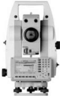
Netzmessung benötigter Passpunkte sowie die Erfassung von Kontrollpunkten erfolgte mit Hilfe eines Tachymeters *LEICA TCRP 1201* (Abb. 2).
